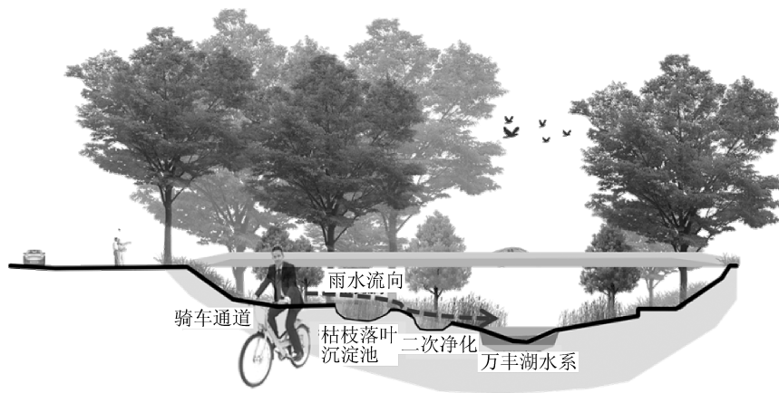
图 1 雨水收集及有机污染物拦截断面
